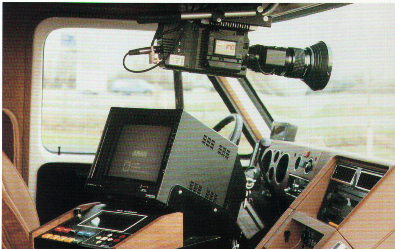
Figuur 7: Wegbeeldcamera voorin het ARAN-voertuig
