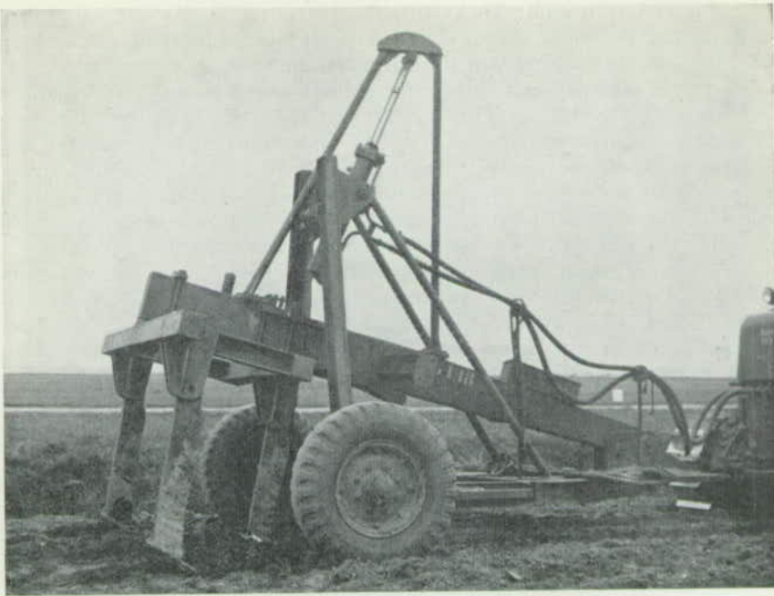
Fig. 13. Ondergrondbreker op greppelploegonderstel: Neptunus. Subsoiler for deep shattering of the soil.
