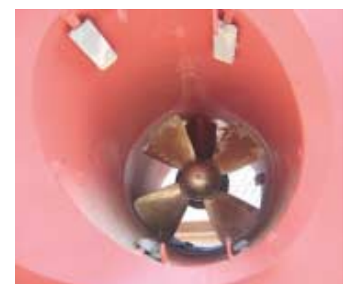
Anodes beschermen de schroef tegen corrosie. (foto: RWS)
