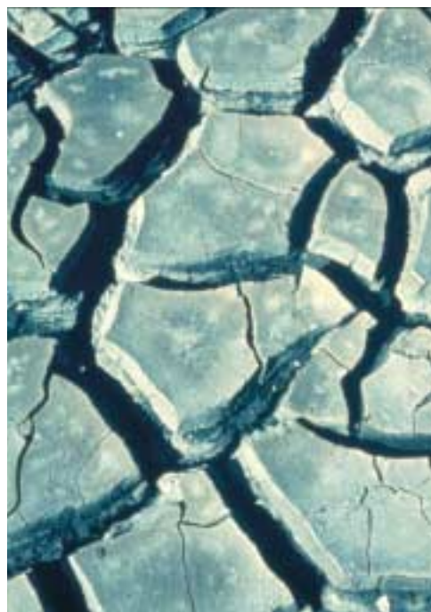
Krimpscheuren in bodem
