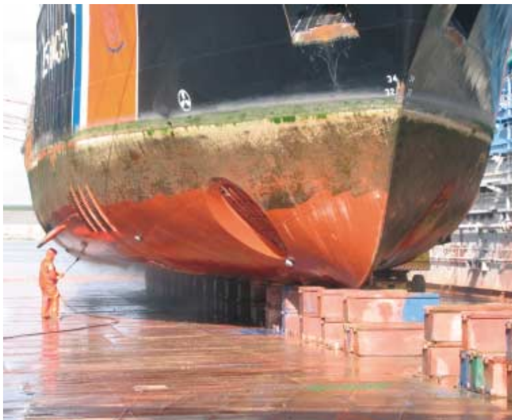
De meeste coatings logen voortdurend verontreinigde stoffen uit. (foto: RWS)
