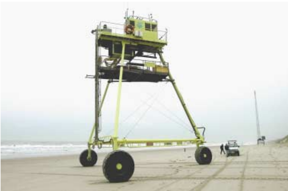
De WESP (Water En Strand Profiler) peilt al rijdend bodemhoogten (op strand én in zee) door de bekende afstand antenne-wielbasis af te trekken van de gemeten (LRK) antennehoogte (t.o.v. NAP).
