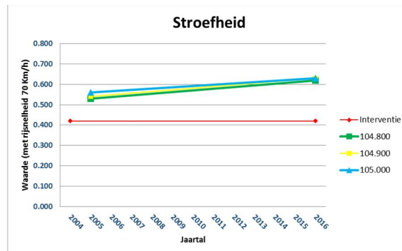
Figuur 14. Proefvak R2 - 2L ZOAB met PMB en synthetische vezels
