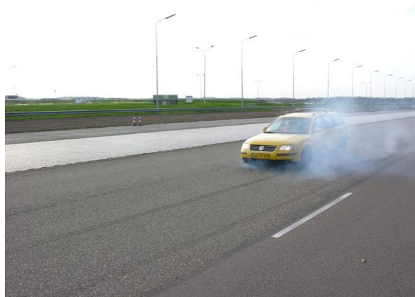
Figuur 2 Meten van remvertraging.
