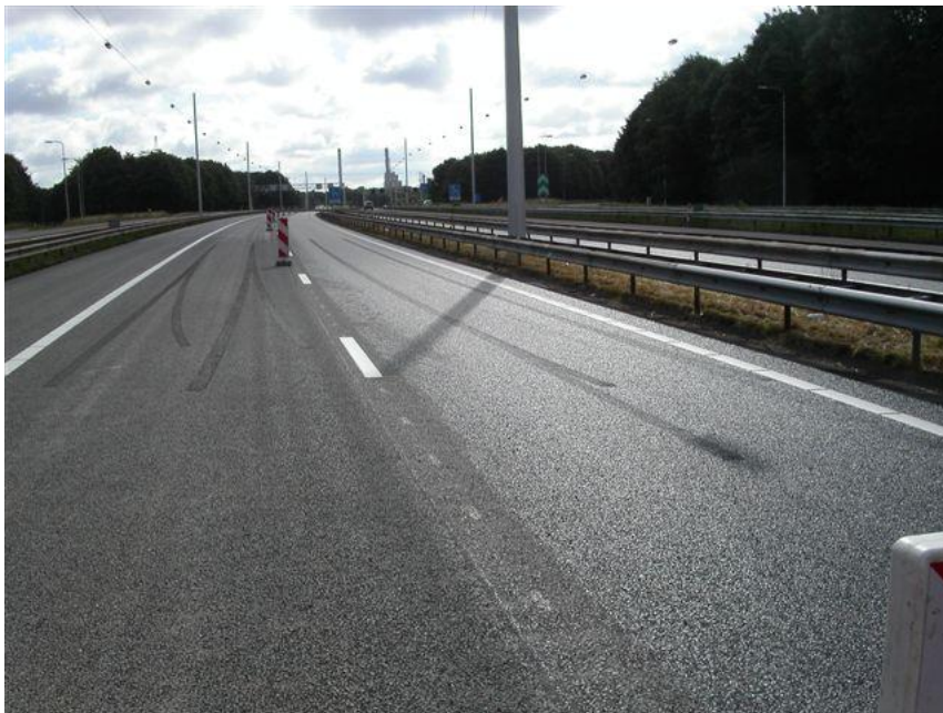
Figuur 4: Remvertragingproeven op afgestrooid wegdek (links op de foto) en niet afgestrooid wegdek (rechts op de foto) op RW76.
