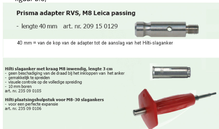
Figuur B.6 Standaard meetbout voor verticale wanden
