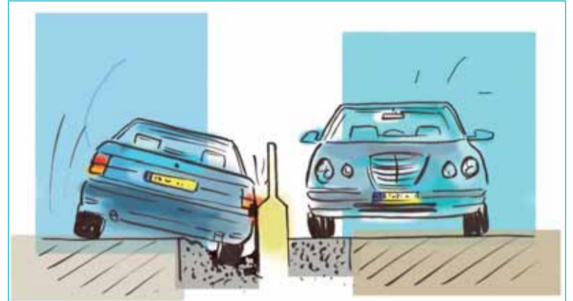
Marjan Daenen van Rijkswaterstaat Zeeland bedacht een methode om de kans te verminderen dat (vracht)wagens kantelen wanneer ze gedeeltelijk in de berm raken. 'Waarom zou de wegberm niet kunnen worden verstevigd met geocrete, een materiaal dat in de waterbouw wordt toegepast om dijklichamen te versterken?'
