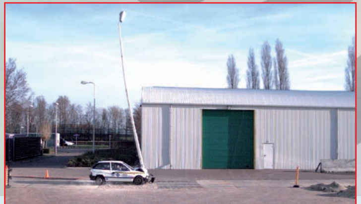
botsproef met een lichtmast
