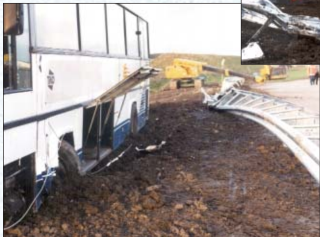
Een flexibele geleiderail (F2m-400-80) kan een bus niet keren. Foto: Rijkswaterstaat
