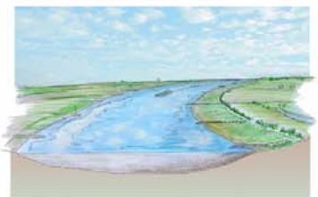
Oeverbelijning in combinatie met kribverkorting
