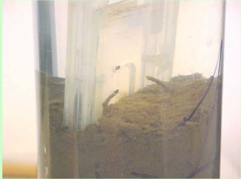
..... Figuur 5.1 Toepassing DGT bij onderzoek naar het gedrag van zware metalen aan het sediment-water grensvlak. In deze opstelling worden tegelijkertijd metingen uitgevoerd met DGT en DET [foto: Chris Naylor, Lancaster University].
