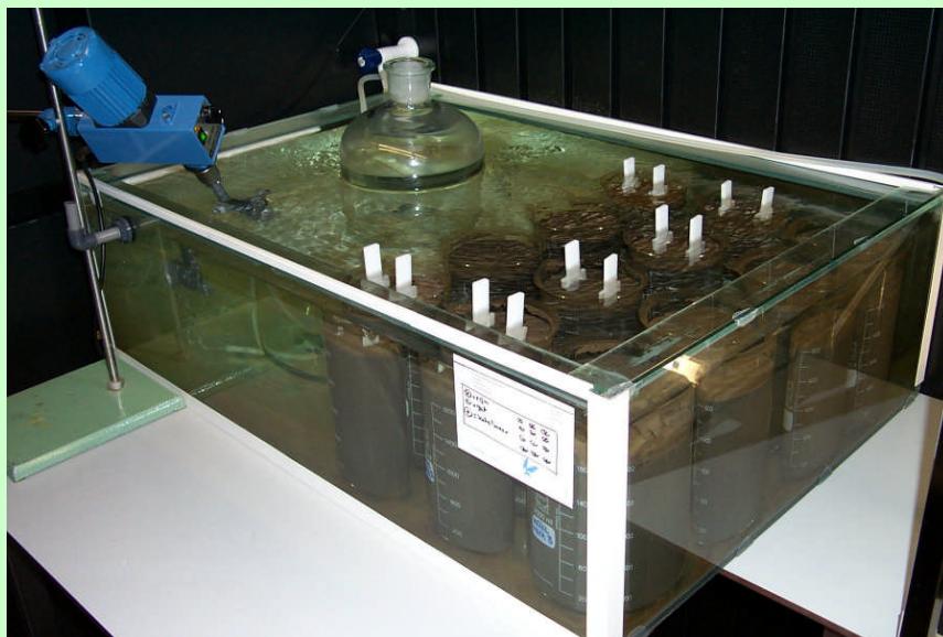
..... Figuur 4.4 Opstelling ten behoeve van een gecombineerd chemisch-ecotoxicologisch onderzoek met onder andere DGT-meetcellen en testorganismen [foto: Gerard Stroomberg, IVM].
