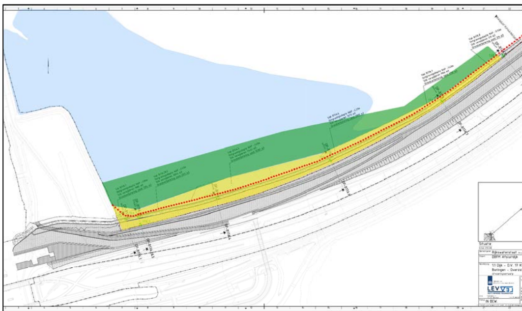
Figuur 2.2 Begrenzing van de te ontgraven Waddenzeebodem in dijkvak 17A (geel). Rode stippellijn: RIP-grens (na verruiming basisplan 2019). Blauw: ondiepte. Groen: gebied waar het ontgraven slib tijdelijk kan worden neergelegd (Bron: Levvel).
