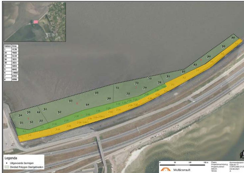
Figuur B2 Begrenzing van de te ontgraven Waddenzeebodem in dijkvak 17A. Groen wordt als eerste ontgraven, gevolg door geel. Grijsgroen: gebied waar het ontgraven slib tijdelijk wordt neergelegd.
