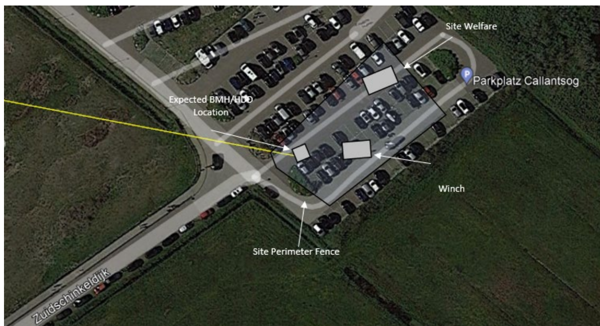
Figuur 3.1 Indicatie werkterrein parkeerplaats voor doortrekken kabel naar BMH
