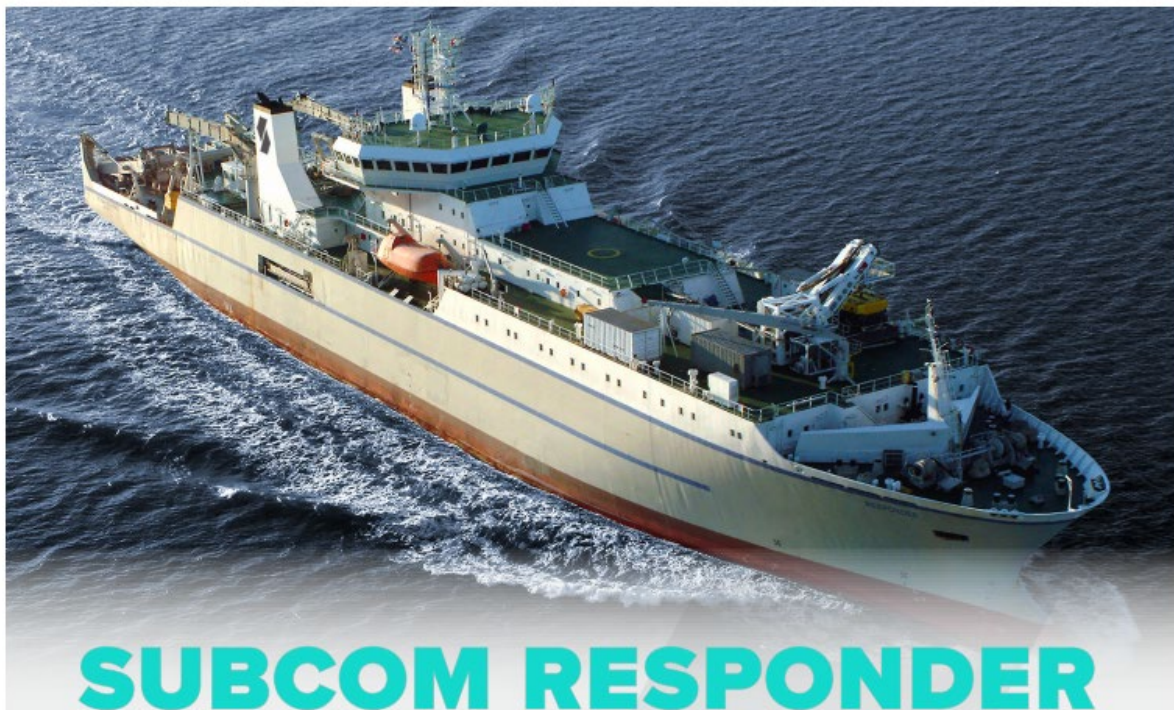
Figuur 5.3 CS Responder kabel installatieschip
