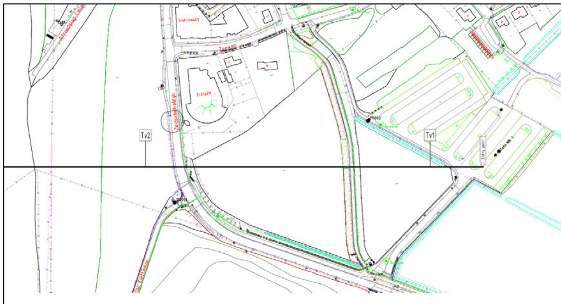
Figuur 2.3a Detail HDD tracé (zwarte lijn) vanaf parkeerplaats ten zuiden Callantsoog (uitsnede uit boorplan)
