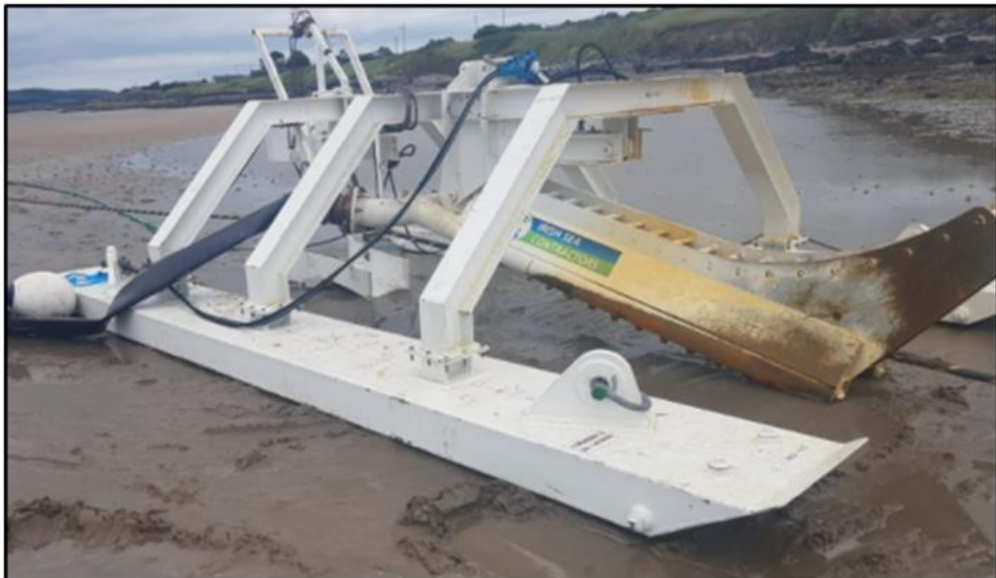
Figuur 2.3 Voorbeeld van een jetting tool zoals zal worden toegepast bij de werkzaamheden
