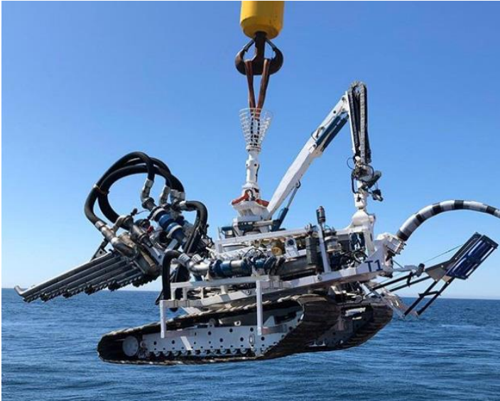
Figuur 2-2 kabel-trench-machine gereedschap T1 zoals zal worden gebruikt om de kabel in te graven tussen de laagwaterlijn en de Capjet 1450.
