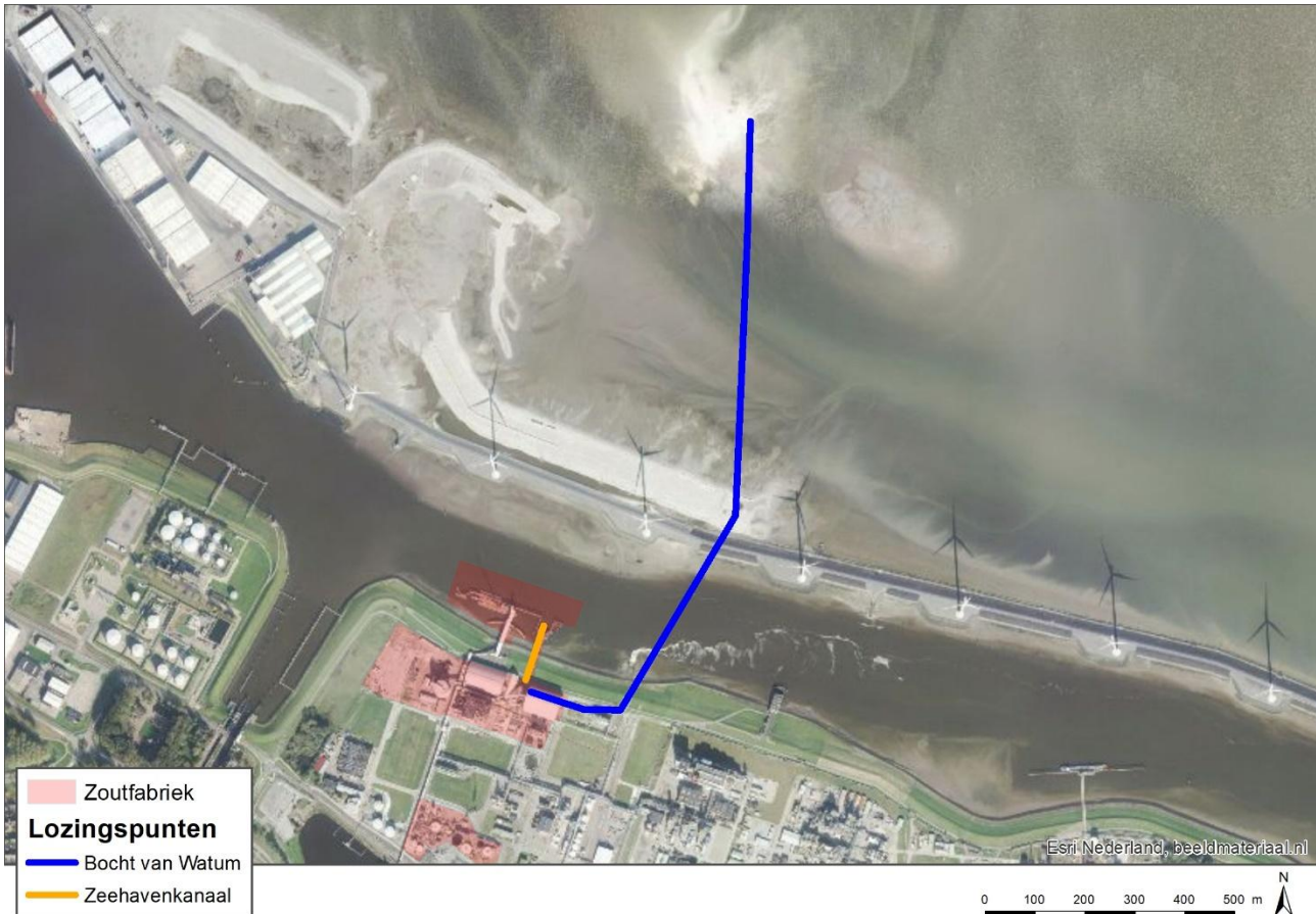
Figuur 5 Ligging van de lozingspunten van de zoutfabriek in het zeehavenkanaal en de Bocht van Watum.
