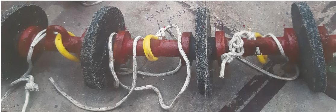
Figuur 2: voorbeeld van een alternatieve grondpees met 24 schijven van 30 cm hoog i.p.v. 12 klossen van 22 cm hoog.
