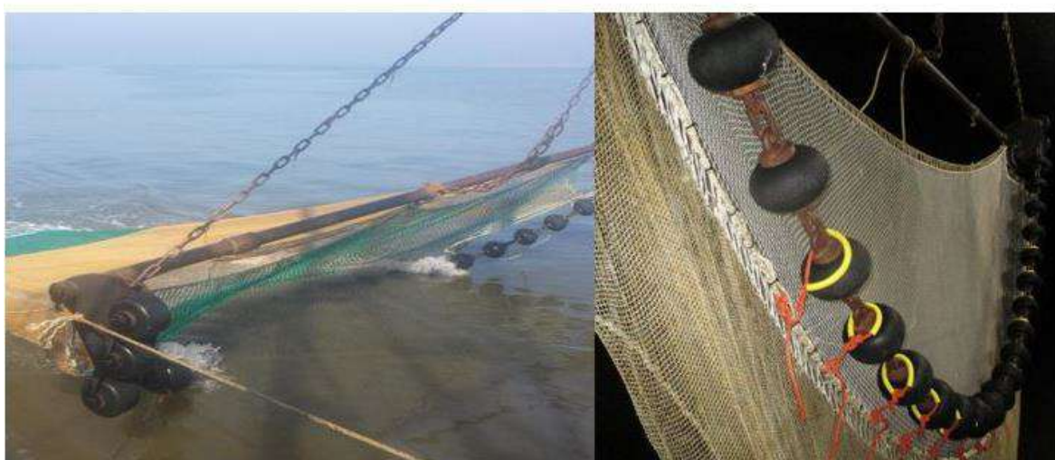
Figuur 2. Schematische tekening en foto van het prototype van de zeefmat. Op de linker foto is een groene zeefmat voor de ingang van het net bevestigd, op de rechter foto is een witte zeefmat zichtbaar achter de klossenpees.
