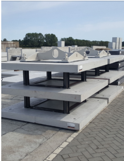
Figuur 2.2. De nieuw ontwikkelde broedstock elementen. De afgebeelde structuren zijn geplaatst in windpark Borssele V.
