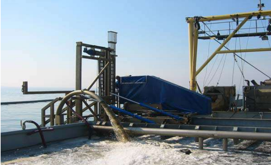
Figuur 6: mosselzaad wordt met een waterstroom aan boord gebracht
