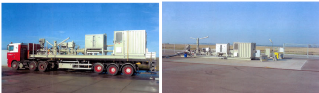
Figuur 2.2: “kiss-skid” op vrachtwagen (links) en geplaatst (rechts)
